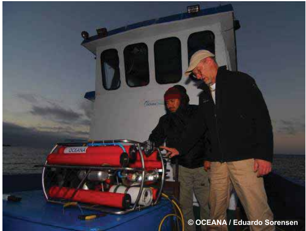
Preparación de ROV antes de expedición.
